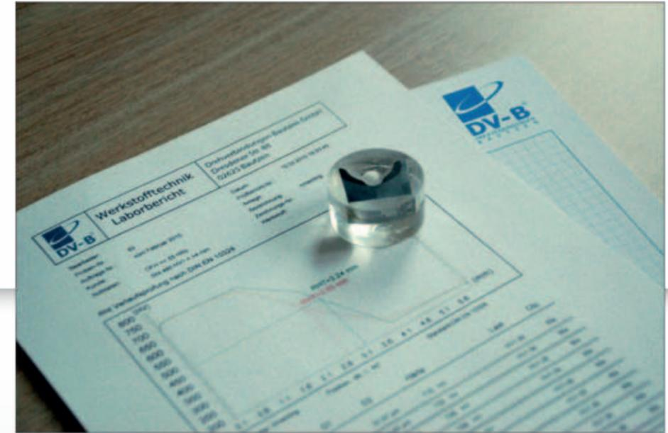
Prüfbericht Härteverlauf · Test report hardness curve
