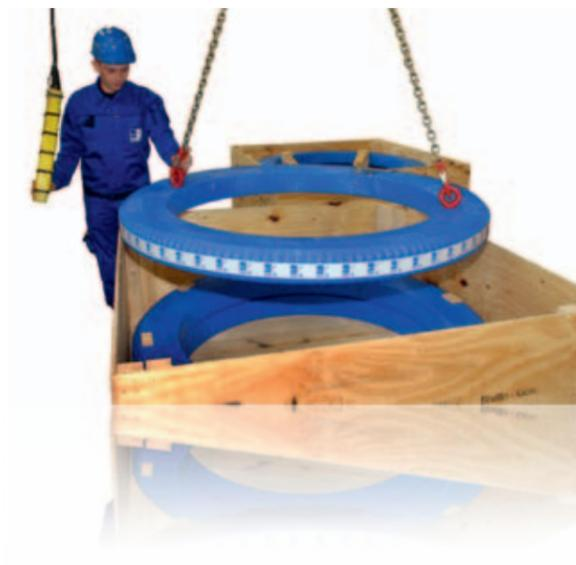
Der Transport darf nur in horizontaler Lage erfolgen. Unbedingt zu vermeiden sind Stöße in radialer Richtung. Eine Ausnahme bildet der Transport von größeren Drehverbindungen in Schräglage, bei denen Transportkreuze oder Aussteifungen zur Anwendung kommen.
